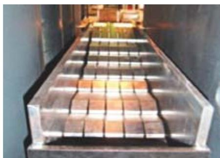
Combustione efficiente con la griglia ad avanzamento
