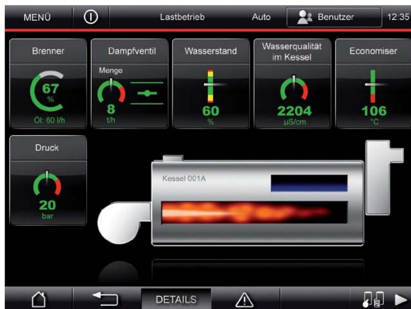
Visualizzazione delle informazioni relative ai parametri della caldaia
