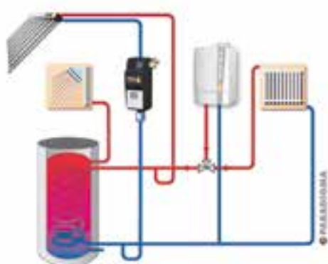
Sistema Aqua con bollitore sanitario
