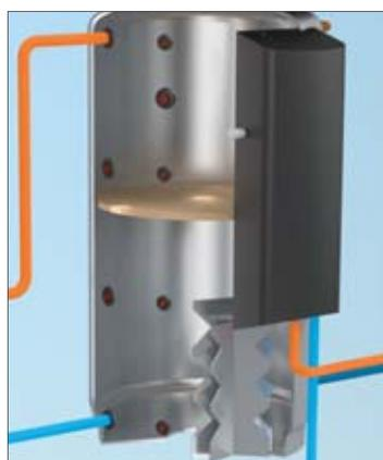
Il Diffusore a Labirinto brevettato Cordivari è un dispositivo che convoglia l'acqua che rientra nel serbatoio dopo lo scambio termico facendo sì che, a qualunque temperatura essa sia, stratifichi al suo interno e si immetta nel volume dell'accumulo senza creare mescolamenti e preservando la stratificazione termica del bollitore.
