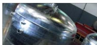
L'utilizzo della zincatura ha l'obiettivo di proteggere l'acciaio dai rischi di corrosione. Il rivestimento di zinco salvaguarda l'intera superficie di accumulo, offrendo una protezione totale ed un lungo ciclo di vita del prodotto. Per mezzo dell'elevata temperatura del trattamento, lo zinco, oltre a rivestire e proteggere l'acciaio dalla corrosione, contribuisce ad offrire una maggiore resistenza meccanica. La Cordivari è dotata di un impianto interno di zincatura a caldo
